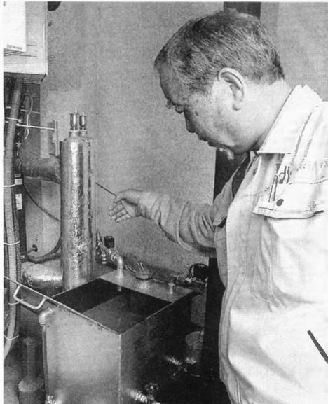
実証試験中のエマルジョン燃料の供給装置を点検する古渡会長（10日、南砺市の福光温泉で）
