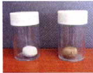
アスベストとフロン分解物(塩化カルシウムなど)を練って(左)加熱すると、アスベストが別の化合物に変化した(右)
