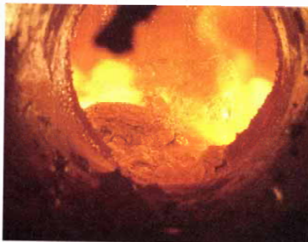
1500℃を超える高温で熔融された飛散性アスベスト(左)は、体積が20分の1のスラグ(ガラス質の固化物)に変わる(上)
