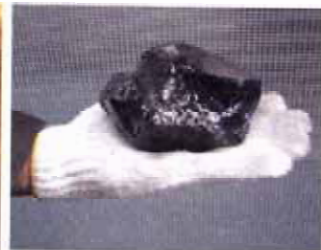
1500℃を超える高温で熔融された飛散性アスベスト(左)は、体積が20分の1のスラグ(ガラス質の固化物)に変わる(上)
