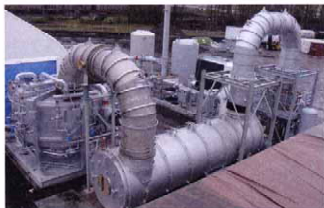
米ワシントン州に設置されたARIテクノロジーズの熱化学変換法(TCCT)プラント。1日25tのアスベスト廃棄物を無害化できる。トルコ向けに同100tの大型も設計中。米国では埋め立てが基本だが、同社は米海軍などと協力して、PCBに汚染されたアスベストの無害化を研究してきた
