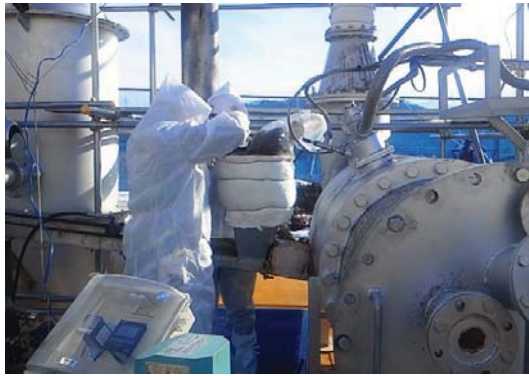
溶融炉への焼却灰試料投入作業
