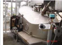
エマルジョンバーナー式表面溶融炉本体(NK-100 処理能力:100kg/h)
